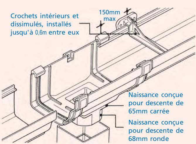
Espacement entre crochets et accessoires : (angles, jonctions et naissances) maximum 15 cm.
